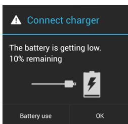
バッテリー充電状態が 10% (2,940mAh バッテリーの場合) または 7% (4,410mAh バッテリーの場合) を下回ったときに、TC55 を電源に接続するように求める通知が表示されます。ユーザーは、次の充電アクセサリのいずれかを使用してバッテリーを充電する必要があります。
