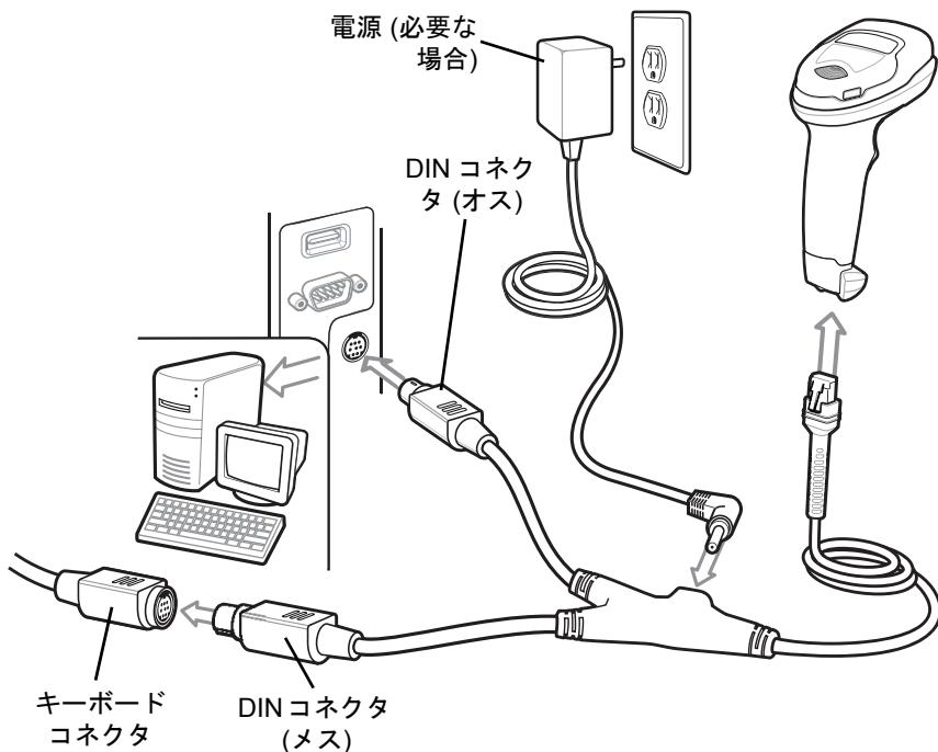
図 10-1 キーボード インタフェースの接続
