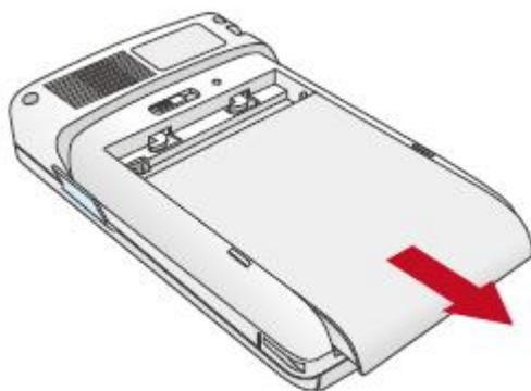
MicroSD スロット
