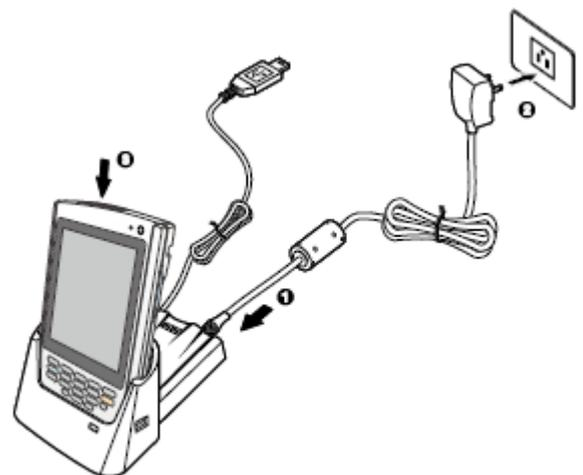
PA520 の底部がクレードルにスムーズに当たると確実に接続が行われ、クレードルと PA520 の LED インジケータが赤く点灯します。
