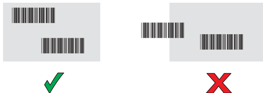
図89 複数のバーコードがある SE2100 照準パターン
