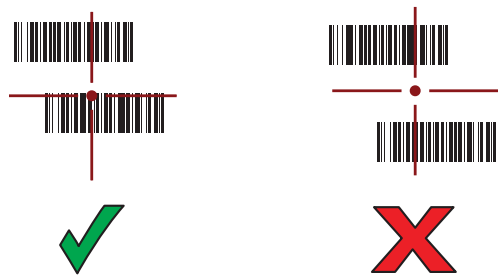
図96 ピック リスト モード: 複数のバーコードが照準パターン内にある場合
