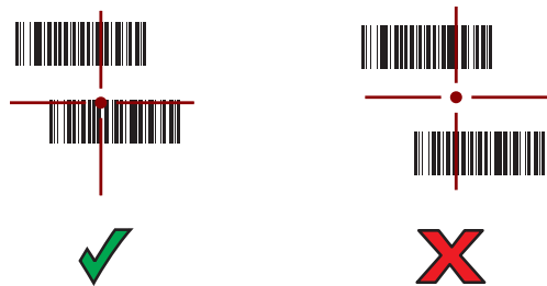
図99 ピック リスト モード: 複数のバーコードが照準パターン内にある場合
