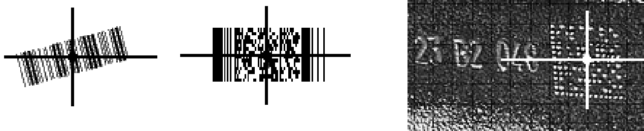
図 3-2 イメージャ照準パターンでのスキャン方向
