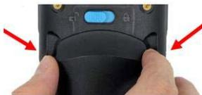
3. バッテリーコンパートメントのプルタブを引いてバッテリーを取り外します。カバーを閉じるときは、プルタブがバッテリーコンパートメントの内側にあることを確認してください。
