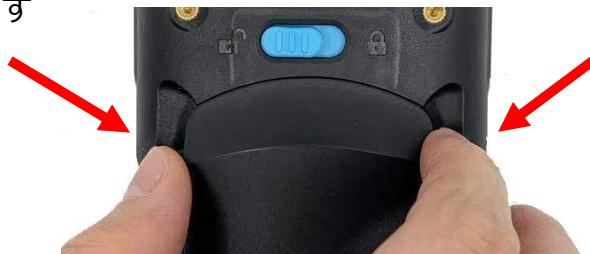
3. バッテリーコンパートメントのプルタブを引いて、バッテリーを取り外します。
