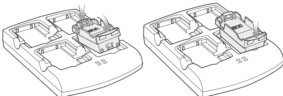
図 127: UBCアダプタ内のバッテリアダプタ
