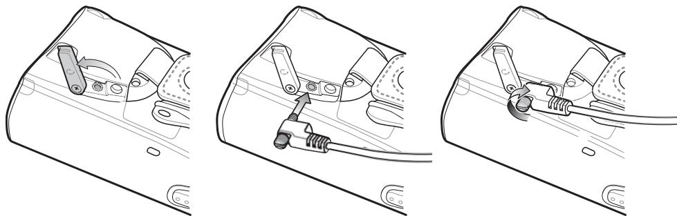
**図 34: MC32N0-G へのヘッドセットの接続**
