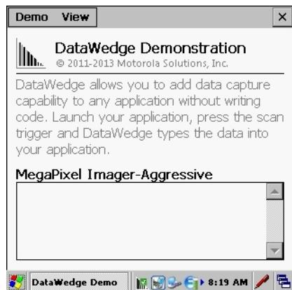
スキャナボタンを押して、バーコードデータを読み取ります。バーコードコンテンツが、テキストボックスに表示されます。
