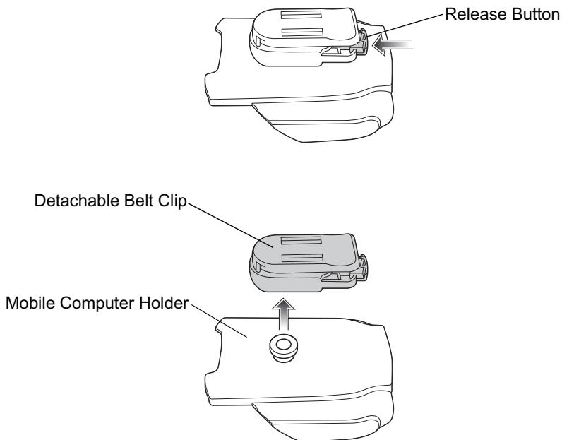
プラスチック ホルスターは、モバイル コンピュータ用のホルダーです。モバイル コンピュータ ホルダーと着脱式ベルトクリップで構成されています。リリース ボタンを押すと、着脱式ベルトクリップが外れます。
