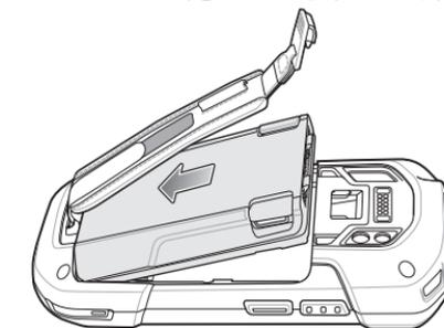
4. バッテリーを下に回転させてバッテリー収納部に入れ、所定の位置にカチッとはまるまで下に押しします。
