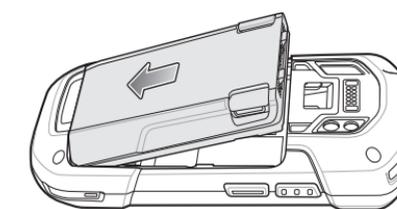
2. バッテリーを下に回転させてバッテリー収納部に入れます。
