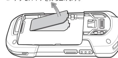
2. microSD カードをカードホルダーに挿入します。カードをカードホルダーの中に押し込みます。
