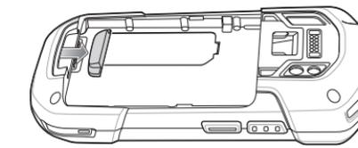
2. ハンドストラッププレートを、ハンドストラップ取り付けスロットに挿入します。
