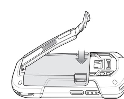
5. ハンドストラップクリップをハンドストラップ装着スロットの位置に持ってきて、所定の位置にロックします。
