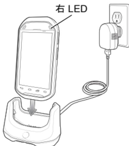
2. MC40 の充電が自動的に開始されます。MC40 は約 4 時間で充電が完了します。
