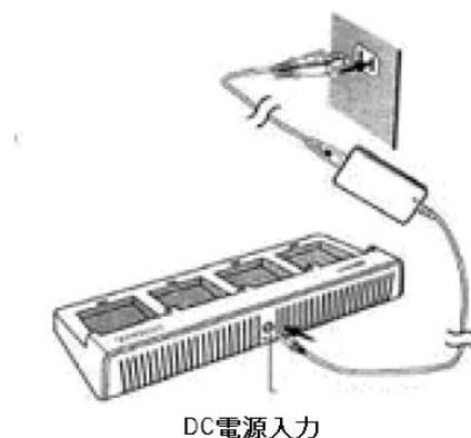
4 個のバッテリーを同時に充電することができます。AC アダプタの DC プラグを充電器の電源ジャックに差し込みます。AC コードを AC アダプタに接続して、AC プラグをコンセントに差し込みます。充電器のバッテリーコンタクトの位置と向きを確認して、バッテリーパックを図に示すようにバッテリースロットにスライドします。
